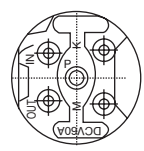
E25或E75 用于带减压阀的首片结构中 M测压口G1/4K供油口G1/4 with reducing valve
